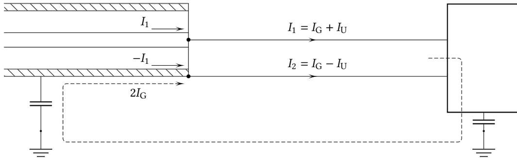
**Abb. 2:** Zur Anregung von Gleichtaktsignalen beim Übergang von unsymmetrischen auf symmetrische Leitungen
