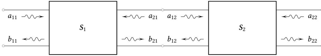
Abb. 4: Zur Kettenschaltung von Zweitoren
