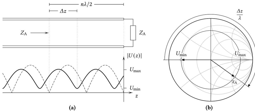
**Abb. 8:** Zur Bestimmung von Betrag und Phase des Abschlussreflexionsfaktors durch Bestimmung der Lage der Spannungsminima bzw. -maxima
