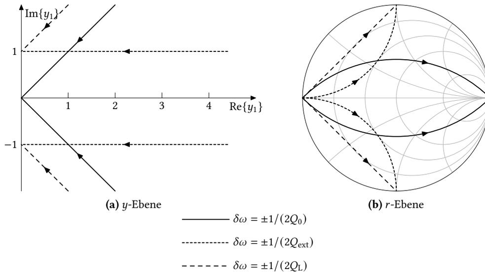
**Abb. 11:** Ortskurven des Klemmenleitwertes eines Reflexionsresonators bei festen Verstimmungen  $\delta\omega$ . Kurvenparameter ist das Ankopplungsmaß  $\kappa$
